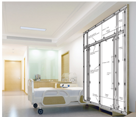
Solución de montaje de paneles: SL-FB1, SL-RLE y SL-C-WW90 - estructura y SL-M10 - panel
